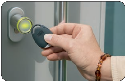
Bild 2: Auf dem Transponder sind die Zugangsdaten gespeichert
