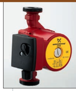
Die »Solar«-Pumpen sind einsetzbar bei Medientemperaturen von -10 bis +110 °C. Der Standardanschluss ist ein Verschraubungsgewinde ISO 228/1 für Rohrgewinde DIN 2999
