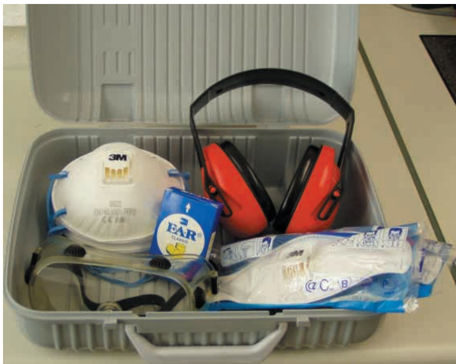
Abbildung 5: Immer griffbereit und sauber gelagert: Die persönliche Schutzausrüstung (PSA) fürs Stemmen, Fräsen, Schlitzzen und Bohren.
